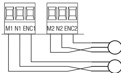
Привод с энкодером (**M1**) =24 В, с задержкой при закрывании
