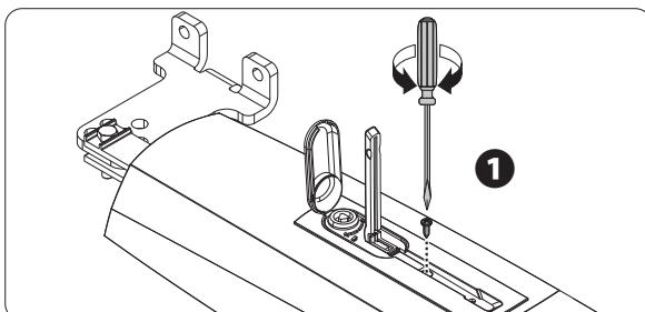
△ **ПЕРЕД ТЕМ КАК СНЯТЬ** крышку 1, обязательно сдвиньте ее.
