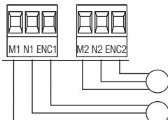
Привод с энкодером (M2) =24 В, с задержкой при **закрывании**.
